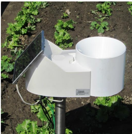
ECO D3 Station mit Solarpanel und Modem
